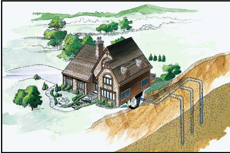
Εικόνα 13: Κατακόρυφο σύστημα αβαθούς γεωθερμίας με παράλληλο γεωεναλλάκτη
